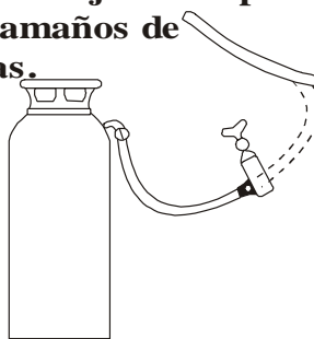
Figura 3. Prueba hidrostática de extintores a través de la manguera
